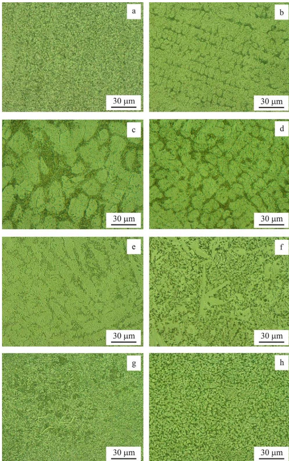
Fig. 1. Metallographic study of selected tin alloys: a) F56, b) F9, c) F34, d) F36, e) F41, f) F44, g) P5, h) P6.
